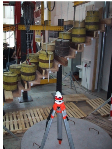
Bild 4 Falwerkterppe bei Belastungsversuch
