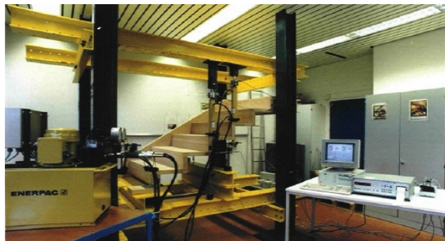
Bild 1 Belastungsprüfung an einer Falwerktrappe
