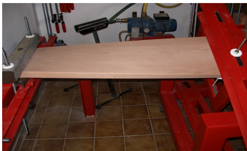
Bild 2 Torsionsversuch an Einzelstufen
