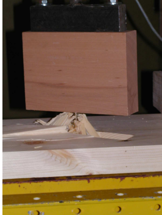
Typischer Holzbruch in der Wange
